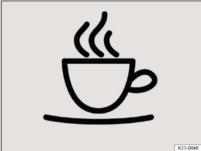
Abb. 1 Im Display des Kombi-Instruments: Symbol Müdigkeitswarnung.
