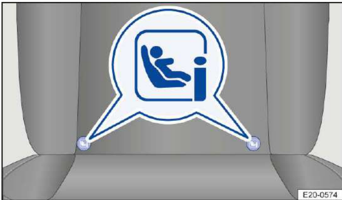
Abb. 1 Am Beifahrersitz: Kennzeichnungsvarianten der ISOFIX- Verankerungspunkte für Kindersitze.
