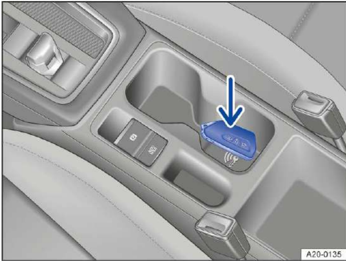
Abb. 1 In der Mittelkonsole: Notstartfunktion.
