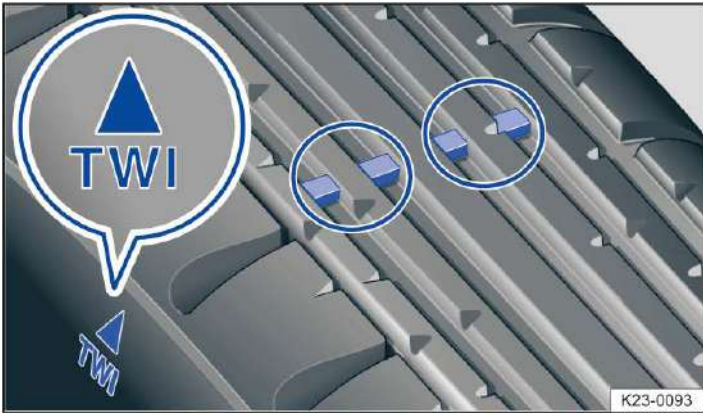
Abb. 1 In den Profiltrillen: Verschleißanzeiger.
