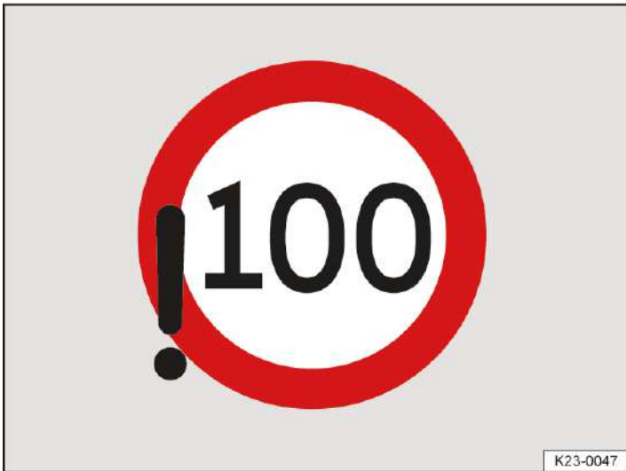
Abb. 1 Im Display des Kombi-Instruments: Erkannte Überschreitung der zulässigen Höchstgeschwindigkeit (Prinzipdarstellung).
