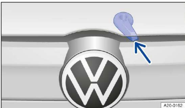
Abb. 2 Über dem Kühlergrill: Öffnungshebel für die Frontklappe.
