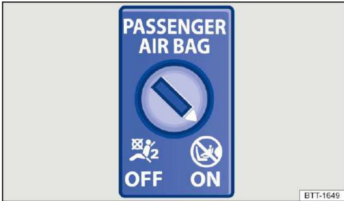
Abb. 1 An der Stirnseite der Instrumententafel: Schlüsselschalter zum Aus- und Einschalten des Beifahrer-Frontairbags.
