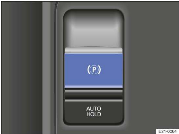
Abb. 1 In der Mittelkonsole: Taste für die elektronische Parkbremse (Prinzipdarstellung).
