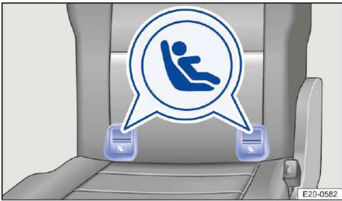
Abb. 3 Am Fahrzeugsitz dritte Sitzreihe: Kennzeichnungsvarianten der ISOFIX- Verankerungspunkte für Kindersitze.
