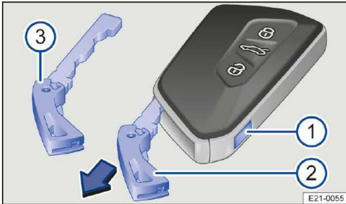
Abb. 1 Fahrzeugschlüssel: Entriegelung des Notschlüssels.
