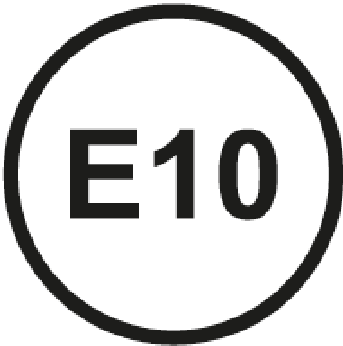
Abb. 3 Kennzeichnung für Benzinkraftstoffe mit 10 % Ethanolanteil.
