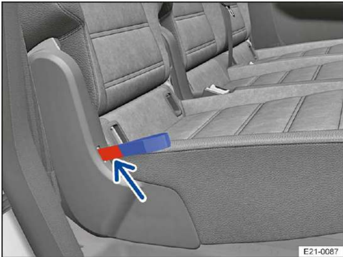
Abb. 3 Zweite Sitzreihe: Markierung für nicht sicher eingerastete Sitzlehne.
