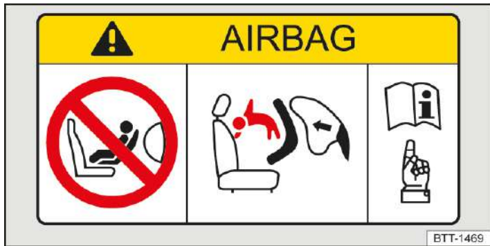
Abb. 1 Prinzipdarstellung: Airbag-Label an der Sonnenblende.
