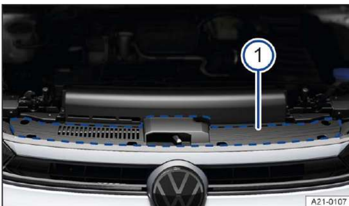
Abb. 2 Im Frontraum: Aufkleber für Motorölnorm und Motorölviskosität (Prinzipdarstellung).
