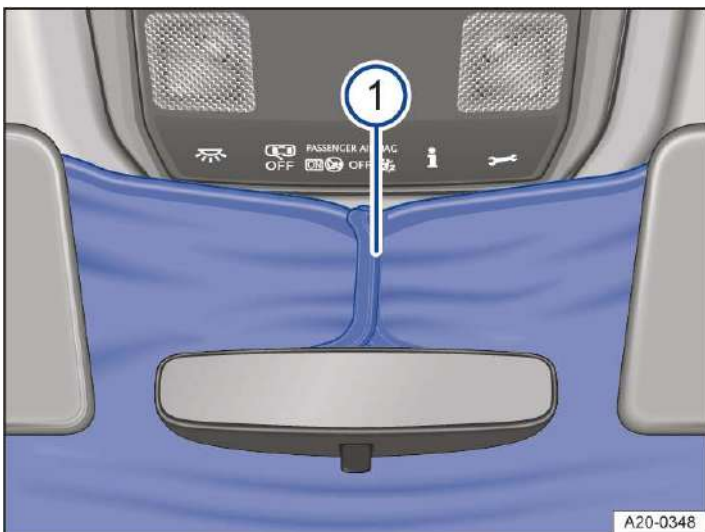
Abb. 2 Am Innenspiegel: Klettverschluss der Verdunkelung.
