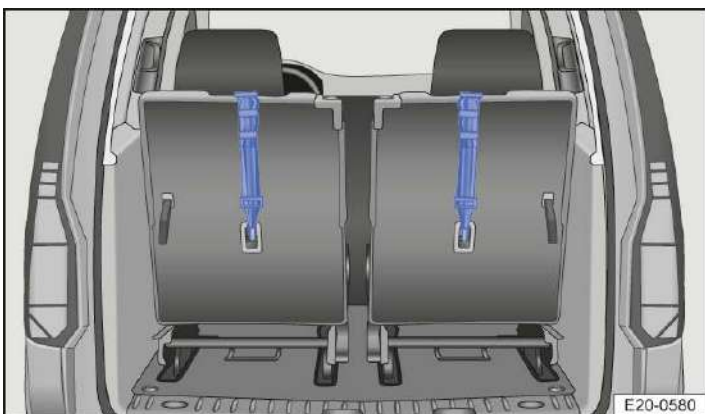
Abb. 4 Dritte Sitzreihe: eingehängte Top Tether-Gurte in Top Tether-Verankerung (ausstattungsabhängig).
