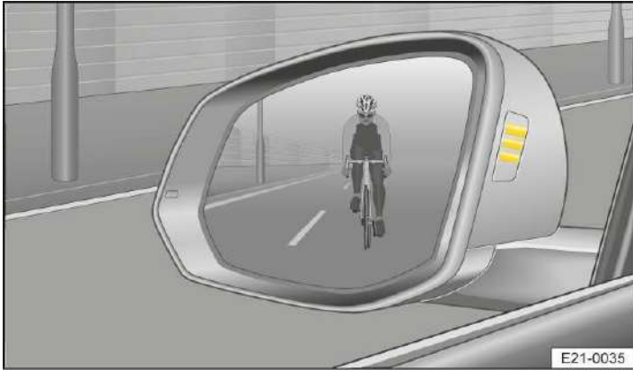
Abb. 1 Im Gehäuse der Außenspiegel: Anzeige der Ausstiegswarnung (Prinzipdarstellung).
