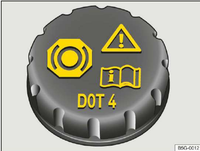
Abb. 1 Im Frontraum: Deckel des Bremsflüssigkeitsbehälters.
