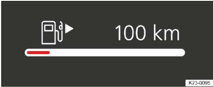
Abb. 1 Im digitalen Kombi-Instrument: Kraftstoffvorratsanzeige (Prinzipdarstellung).
