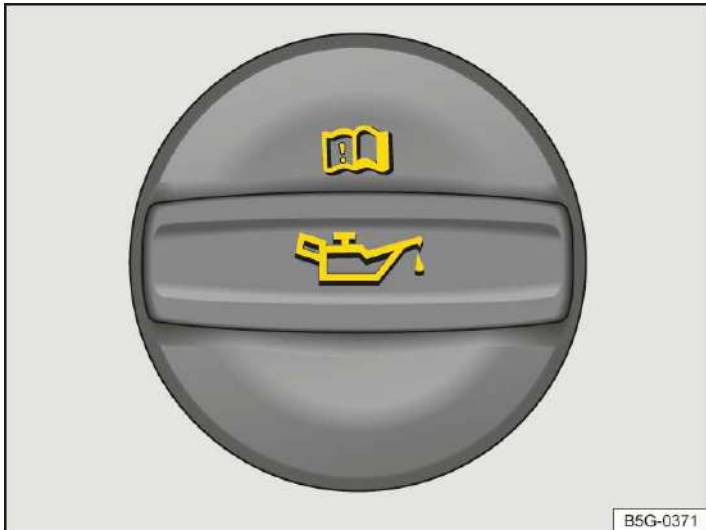
Abb. 1 Im Frontraum: Deckel der Motoröl-Einfüllöffnung (Prinzipdarstellung).
