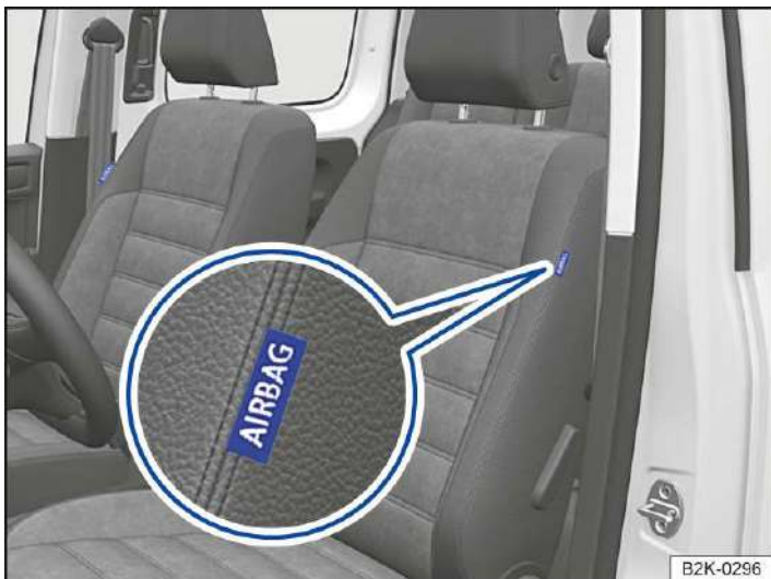
Abb. 2 Seitlich im Vordersitz: Einbauort des Seitenairbags.
