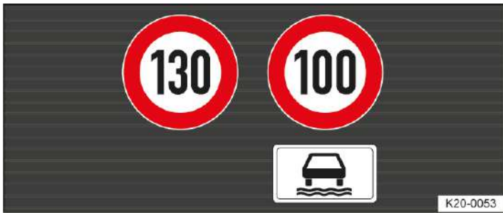
Abb. 2 Im Display des Kombi-Instruments: Anzeigen der Verkehrszeichenerkennung mit erkanntem Zusatzzeichen (Prinzipdarstellung).
