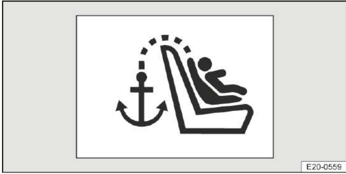
Abb. 1 Prinzipdarstellung: Kennzeichnung für Top Tether-Verankerung.
