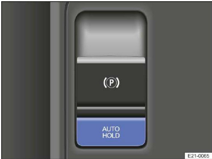
Abb. 1 In der Mittelkonsole: Taste für Auto Hold.
