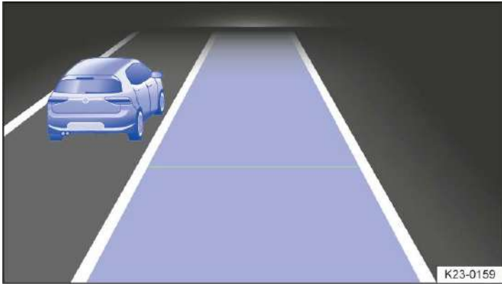
Abb. 1 Im Display des Kombi-Instruments: Langsameres Fahrzeug auf der linken Spur erkannt (Prinzipdarstellung).
