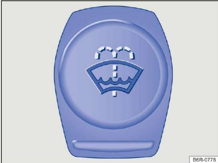
Abb. 1 Im Frontraum: Deckel des Scheibenwaschwasserbehälters.
