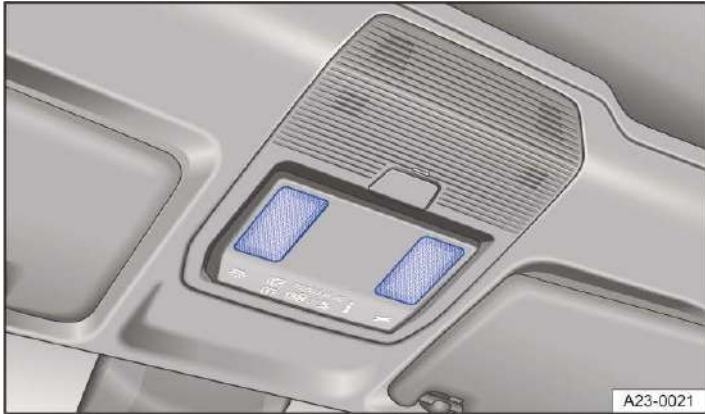
Abb. 1 In der Dachkonsole: Berührungssensitive Leseleuchten.
