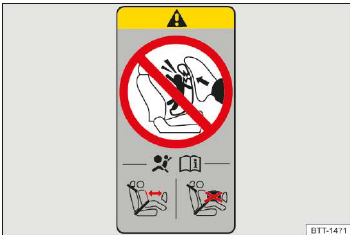
Abb. 2 Prinzipdarstellung: Airbag-Label an der B-Säule.
