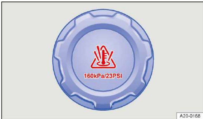
Abb. 1 Im Frontraum: Deckel des Kühlmittelbehälters.
