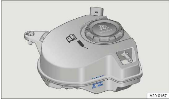
Abb. 2 Im Frontraum: Markierung an dem Kühlmittelbehälter (Prinzipdarstellung).
