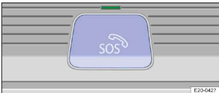
Abb. 2 In der Dachkonsole: Taste für Notrufsystem eCall (hinter Tastenabdeckung) und Kontrollleuchte.
