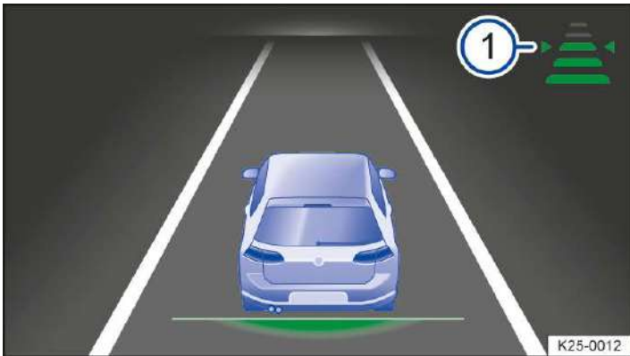
Abb. 1 Im Display des digitalen Kombi-Instruments: Eingestellter Abstand 1 , ACC regelt (Prinzipdarstellung).
